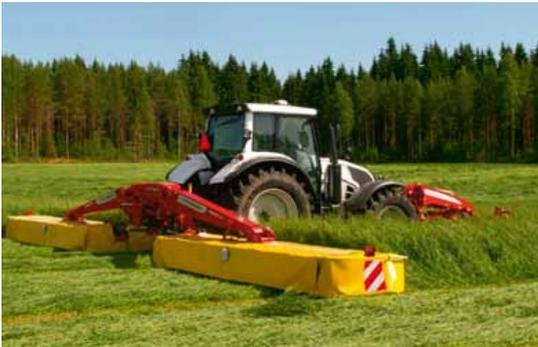
PÖTTINGER marca nuevas pautas en potencia y eficiencia. La NOVACAT S12 es la mayor combinación de segadoras suspendidas del mercado. La nueva "ahorradora de combustible" ofrece un ancho de trabajo pleno de 11,20 m con una potencia necesaria de solamente 160 CV y escaso consumo de combustible.
